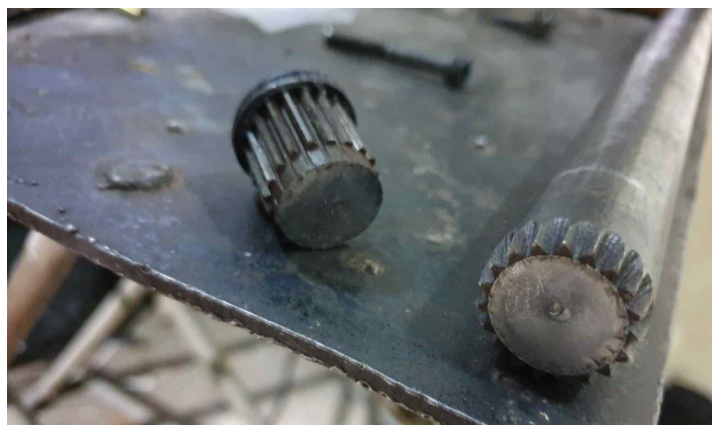
< 파손된 DF-20 Drive shaft >
